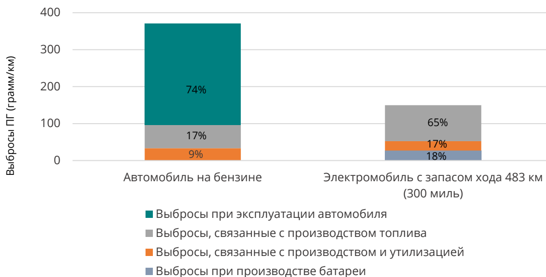
Рисунок-2. Выбросы в течение жизненного цикла автомобиля на бензине и электромобиля*
